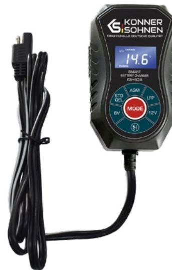
Цей автоматичний зарядний пристрій призначений для використання від мережі живлення з номінальною напругою 230 В. На дроті заряду він має роз'єм SAE за допомогою якого можна змінювати типи клем "кородил" або кільцеві (постачаються в комплекті), а за допомогою спеціальної насадки, що постачається в комплекті з пристроєм, ви можете змінювати полярність дротів.
