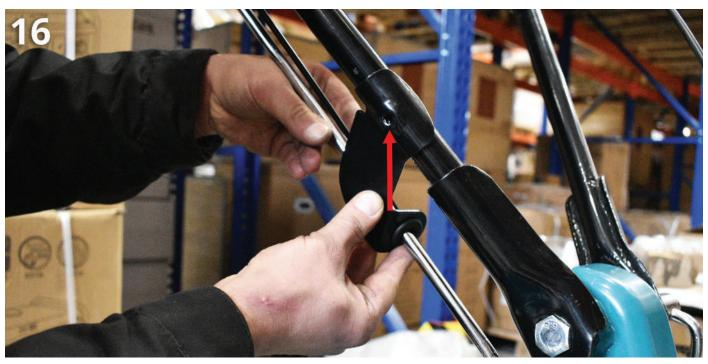
Fig. 17. Attach the shift lever to the stem.
