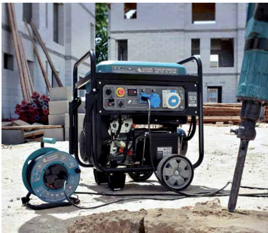
Le groupe essence ouvert KS 15-1E ATSR, d'une puissance maximale de 12,5 kW, est doté d'un moteur 2 cylindres à quatre temps avec un refroidissement par air (22 ch). Il peut être démarré de façon manuelle ou électrique, et peut aussi se connecter à une unité ATS de déclenchement automatique en cas de coupure de courant. Il dispose d'une prise Schuko 230 V, d'une prise CEE 230 V 32A, d'une prise CEE 230 V 63 A, et d'un réservoir en acier d'une contenance de 55 litres. Son panneau de commande intègre un compteur horaire et l'indication de la fréquence, de la tension et du niveau d'huile.
