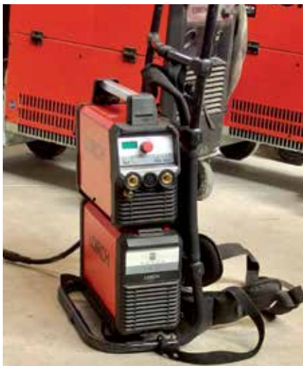
L'objectif de l'entreprise est de proposer des produits qui apportent des solutions à ses clients, comme ce poste à électrodes et Tig Lorch sur batterie, qui permet de travailler en itinérance avec 20 minutes effective de soudage.
