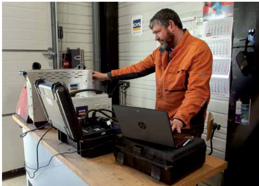
L'entreprise assure l'étalonnage des postes de soudure, sur place ou sur site.
