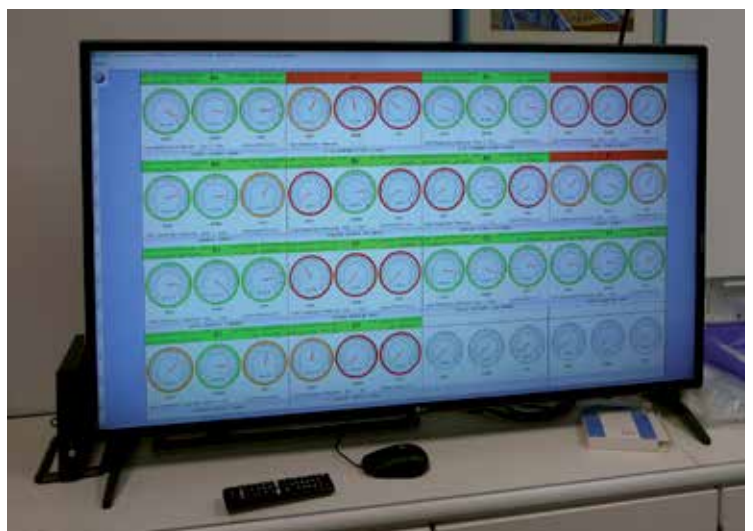
Les unités de production sont monitorées par le système Captor qui actualise les performances de chaque machine en temps réel. Divers outils sont utilisés dans cette gestion dont cet écran qui visualise les rendements des différentes installations.
