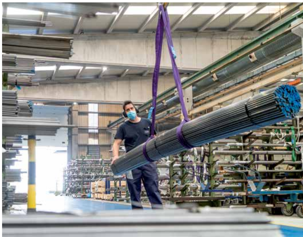
Ayant comme politique de viser un haut niveau qualitatif, Izar Cutting Tools approvisionne sa matière première uniquement de sources européennes, Erasteel en France et Böhler en Autriche. Les barres sont coupées à dimension sur place.
