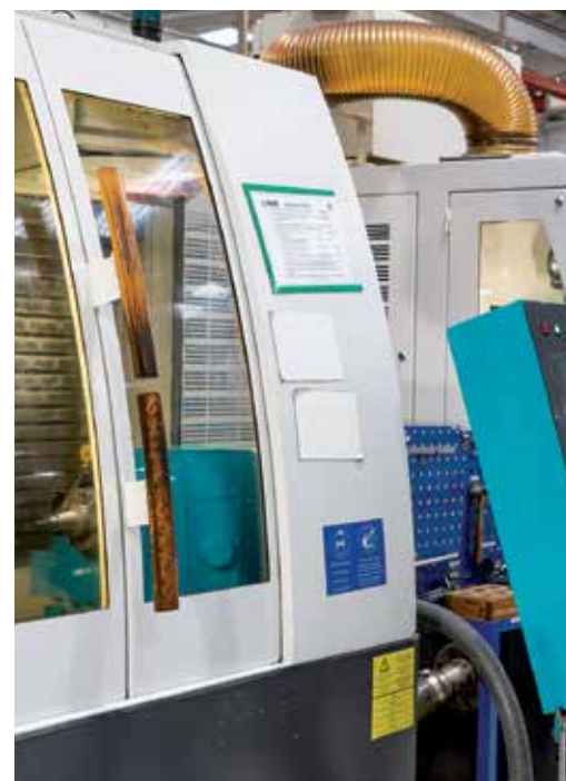
Les îlots de machines sont gérés par un seul opérateur. Ici des ensembles avec d'une part des rainureuses de nouvelle génération Haux dont un grand nombre ont été intégrés à l'usine ces dernières années, et d'autre par des rectifieuses Gemini Schneeburger.
