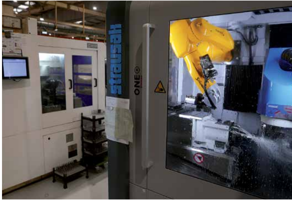
L'unité de production d'outils carbure comporte trois centres d'usinage et un quatrième dédiée à la reprise des arêtes.
