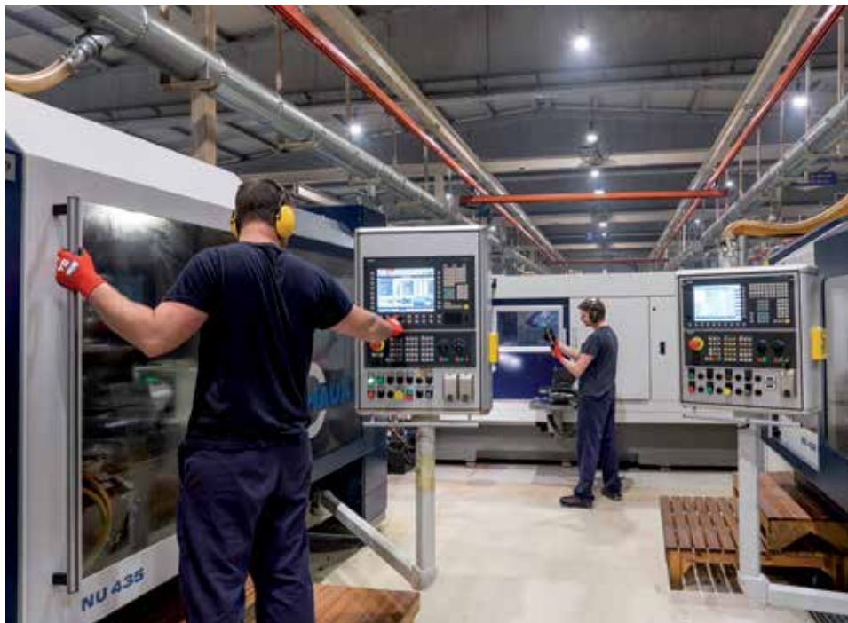
Les îlots de machines sont gérés par un seul opérateur. Ici des ensembles avec d'une part des rainureuses de nouvelle génération Haux dont un grand nombre ont été intégrés à l'usine ces dernières années, et d'autre par des rectifieuses Gemini Schneeburger.
