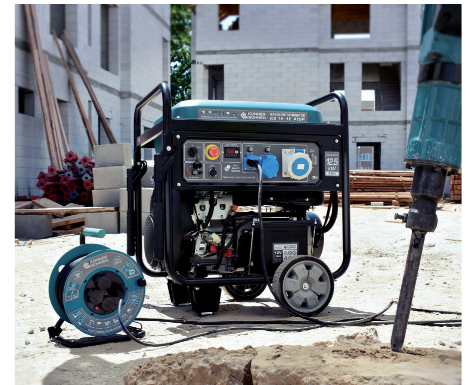
Le groupe essence ouvert KS 15-1E ATSR, d'une puissance maximale de 12,5 kW, est doté d'un moteur 2 cylindres à quatre temps avec un refroidissement par air (22 ch). Il peut être démarré de façon manuelle ou électrique, et peut aussi se connecter à une unité ATS de déclenchement automatique en cas de coupure de courant. Il dispose d'une prise Schuko 230 V, d'une prise CEE 230 V 32A, d'une prise CEE 230 V 63 A, et d'un réservoir en acier d'une contenance de 55 litres. Son panneau de commande intègre un compteur horaire et l'indication de la fréquence, de la tension et du niveau d'huile.
