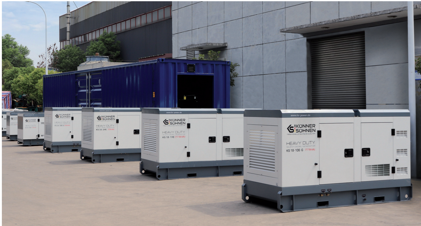
Logé dans un caisson insonorisé anti-vandalisme traité anticorrosion, le groupe Könnner & Söhnen KS 18-1DE-G Heavy Duty de 17,6 kVA est équipé d'un moteur diesel quatre cylindres Deutz 1 500 tr/min à basse vitesse refroidi par eau. Il intègre le préchauffage avant démarrage, est doté d'une unité de commande numérique et comporte deux prises Schuko 230 V et une prise CEE 230 V 32 A.
